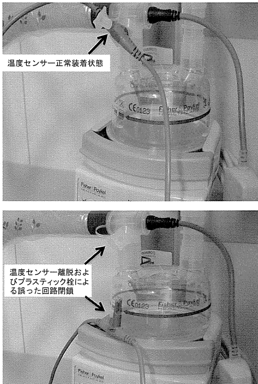
図 6. 温度センサー離脱に対する誤った対応
